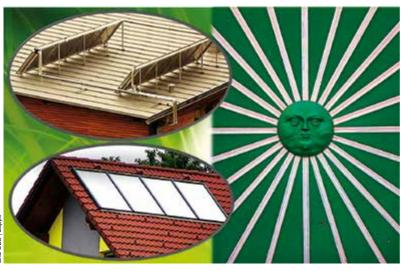
Die Wärme aus Solarthermie-Anlagen kann zur Warmwasserbereitung, Raumheizung. für betriebliche Prozesse oder Schwimmbäder genutzt werden Meistens werden dafür Flachkollektoren ver wendet, die auf das Dach montiert werden
