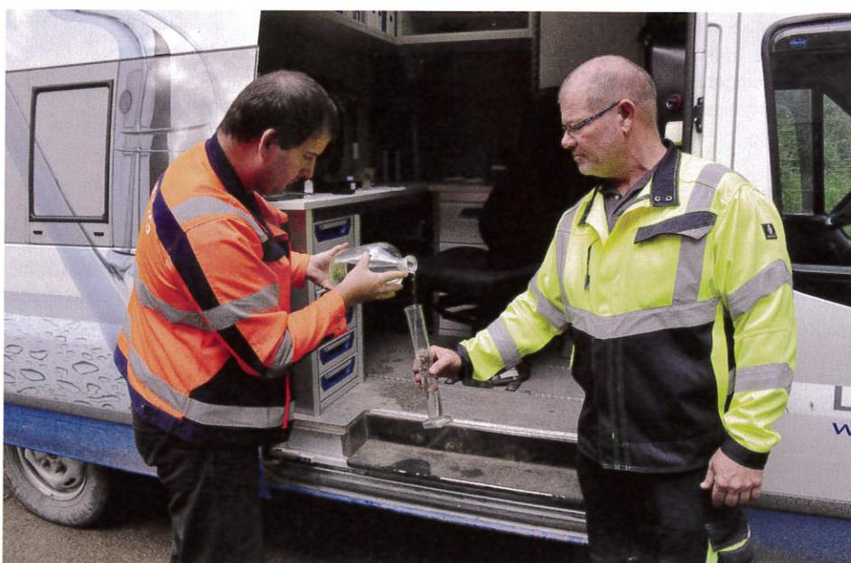
Die LINZ AG hat die Stadtbetriebe mit Know-how und einem geeigneten Chlorierungsgerät unterstützt. Howard Purner von der LINZ AG (links) und Erwin Stöger von den Stadtbetrieben Steyr kontrollieren den Chlorgehalt im Wasser.
